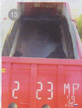
>>> Состояние дна самосвала после выгрузки МАК-смеси – стекание битума отсутствует
